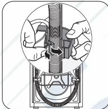
Отсоедините шнур питания и шланг от разъемов на задней панели устройства.
