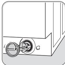
Вставьте заглушку обратно в шланг аварийного слива и установите его на место. Установите фильтр на место, аккуратно вставив его по направляющим. Плотнo закрутите крышку насоса, вращая ее по часовой стрелке.
