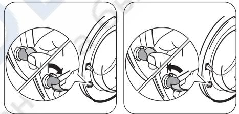
Для **включения** этого устройства поверните по часовой стрелке кнопку с внутренней стороны дверцы (не нажимая ее) так, чтобы паз пришел в горизонтальное положение. При необходимости используйте для этого монету.
