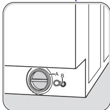
Поставьте рядом с насосом (А) емкость для сбора воды, которая может вытечь. Выньте шланг аварийного слива (В), поместите его конец в поставленный тазик и снимите с него заглушку.
